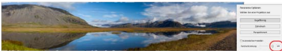
Randverkrümmung, mit der mehr Bildinhalt im Grenzbereich beibehalten wird; Einstellung des Reglers von 0 (oben) bis 90 (unten)
