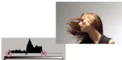
Reglerstellungen korrigiert, damit im Ergebnis der volle Tonwertbereich genutzt wird
